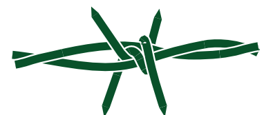
Bouclage type IOWA Bouclage entrelacé dans le cordon
