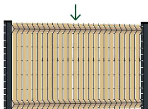
3. Commencez par insérer une lame au milieu du panneau pour maintenir les profils horizontaux, puis insérez toutes les lames.
